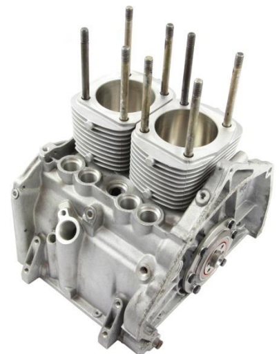
Ansicht Motorgehäuse mit Zylindern
