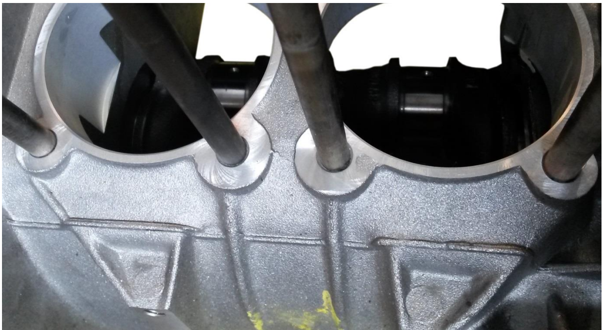
Ansicht Motorgehäuse, Zylinder-Aufnahmefläche, geplant
