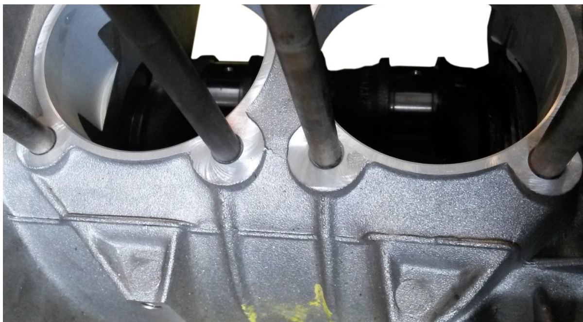
Vista blocco motore, piano di appoggio cilindri rettificato
